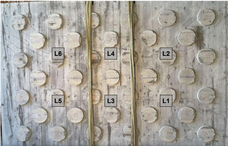
Abb. D.17: Unterseite des Betonquerschnitts der Deckenplatte mit Betonnocken und angezeichneten Rissen. Die Schädigung der Verbundmittel im inneren Bereich ist erst bei Separation der beiden Teilquerschnitte durch den noch ausgeprägten Haftverbund in Feldmitte aufgetreten und ist nicht bei der Versuchsdurchführung entstanden.
