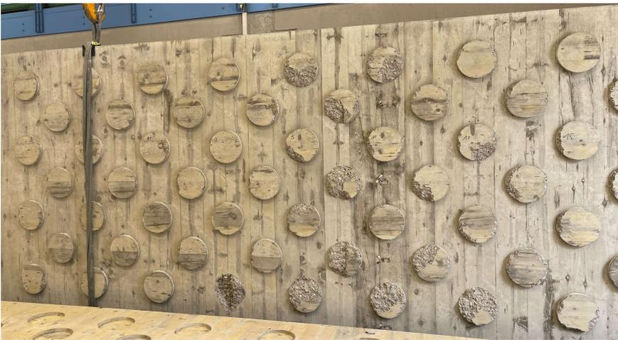
Abb. D.8: Unterseite des Betonquerschnitts des Deckenstreifens mit Betonnocken. Die Schädigung der Verbundmittel im inneren Bereich ist erst bei Separation der beiden Teilquerschnitte durch den noch ausgeprägten Haftverbund in Feldmitte aufgetreten und ist nicht bei der Versuchsdurchführung entstanden.
