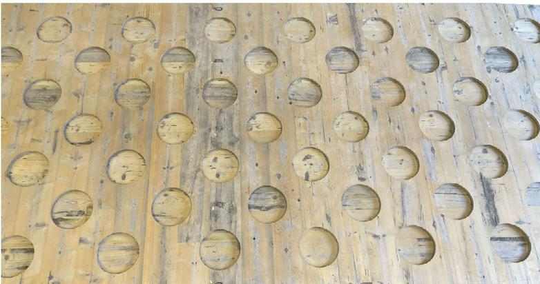
Abb. D.6: Ausschnitt der Oberseite des BSP-Querschnitts des Deckenstreifens mit eingefrästen Verbundmitteln nach Versuchsende
