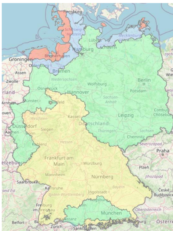
Abbildung 64: Erweiterte Windzonen in Deutschland nach der DIN EN 1991-1-4/NA:2010-12 (Dlubal Geo-Zonen-Tool für Lastermittlung) (Quelle: modifizierte Darstellung nach [130] nach [140, 148, 150])
