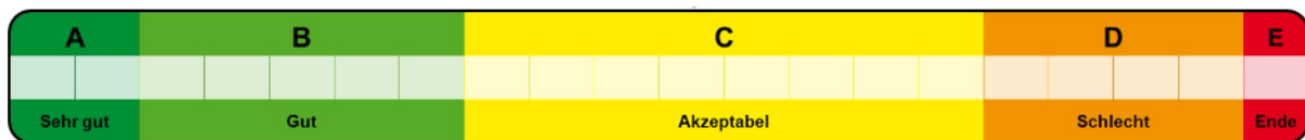
Abbildung 72: Ausschnitt der Darstellung der Bauteilzustände in Dysisko (nach OPKI) (Quelle: eigene Darstellung)
