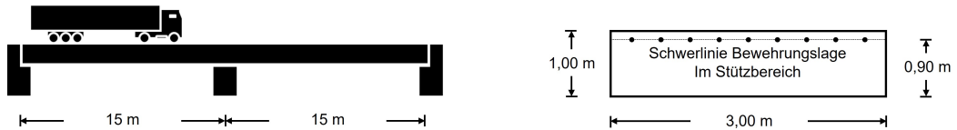
Abb. 6.10: Zweifeldrige Straßenbrücke: Längsansicht (links) und Querschnitt (rechts)
