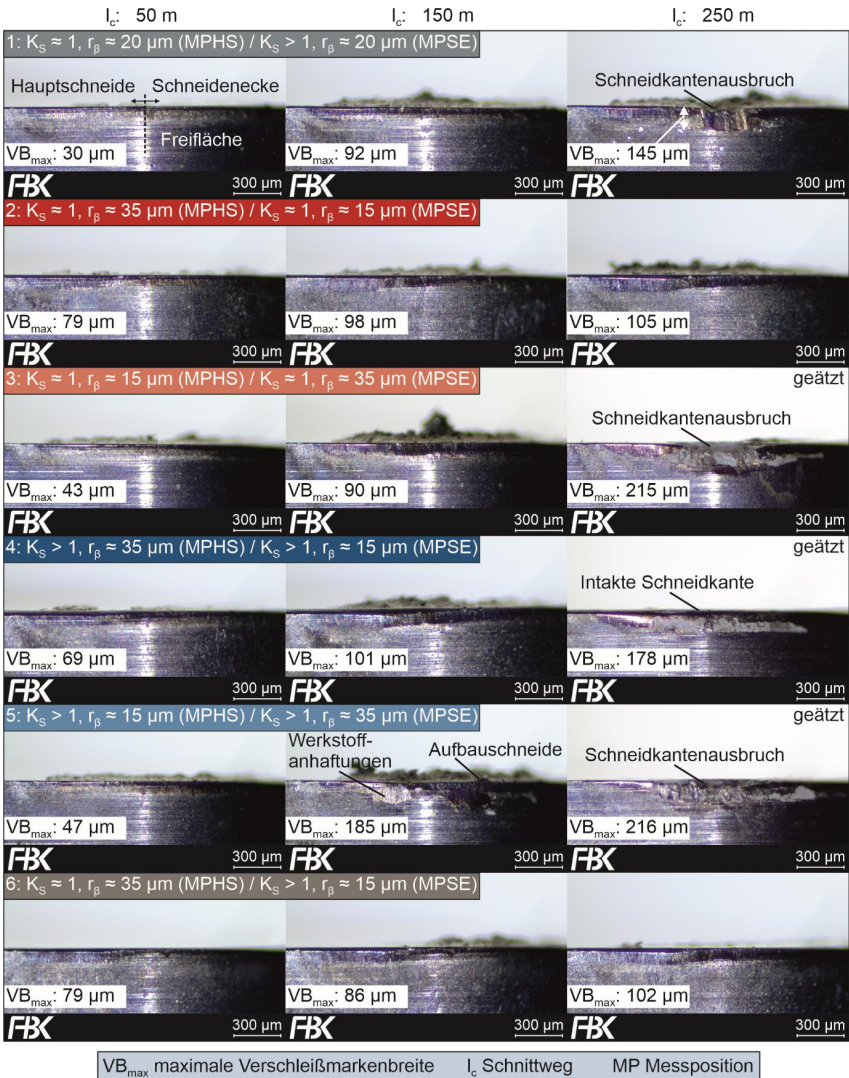
Abbildung 10-41: Einfluss des Schnittwegs l_c auf den Verlauf der maximalen Verschleißmarkenbreite VB_{max} an der Werkzeugfreifläche, modifiziert nach [Hart21, Hart18]
