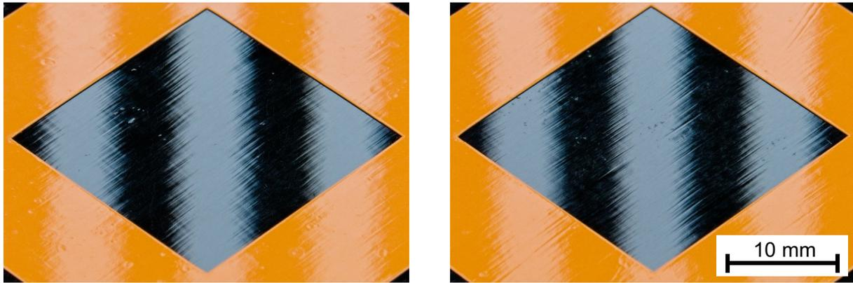
Abb. 3.15: Abweichende Erscheinung von Oberflächen mit ähnlichen Werten von  $S_z$  und  $S_{ku}$ , S-08 (links) und S-11 (rechts), Ausspiegelung mit Streifenraster
