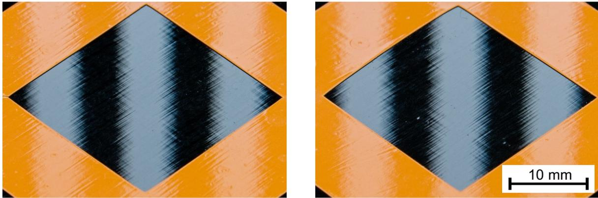
Abb. 3.17: Proben mit hohem (S-04, links) und niedrigem (S-06, rechts) Wert von  $R_{q\ 90^\circ}$ , Ausspiegelung mit Streifenraster
