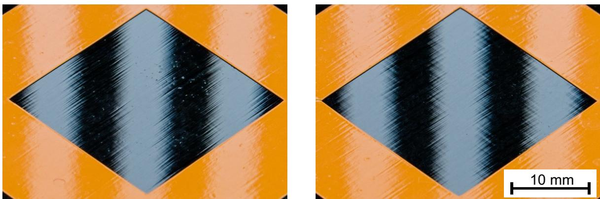
Abb. 3.14: Proben mit hoher (S-02, links) und niedriger (S-04, rechts) Porenanzahl bei sonst vergleichbarer Oberfläche, Ausspiegelung mit Streifenraster
