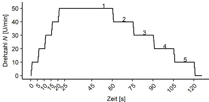
Abb. 4.14: Messprofil mit Vorscherphase und Nummerierung der Stufen der Messphase.
