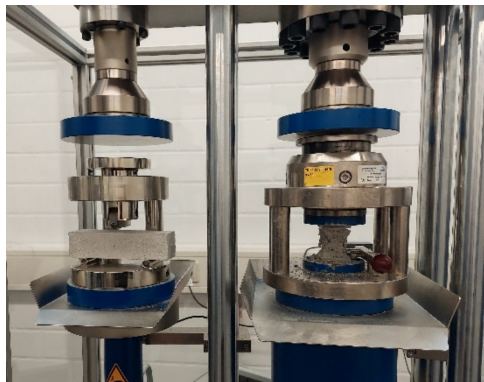
Abb. 4.17: Bestimmung von Biegezug- und Druckfestigkeit nach DIN EN 196-1 mit der kombinierten Druck- und Biegezugprüfmaschine ZK 300-15 (TESTING Bluhm & Feuerherdt GmbH).
