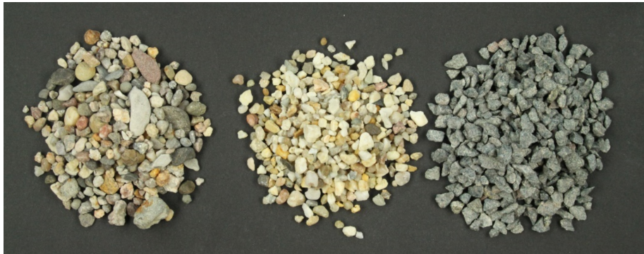
Abb. 2.14: Verwendete Gesteinskörnungsarten zur Auswahl der Einzelkörner, hier dargestellt sind Schüttungen mit Körnern zwischen 2 mm und 8 mm Siebgröße: Rheinkies (links), Quarzkies (mittig) und gebrochener Mikrodioritsplitt (rechts).
