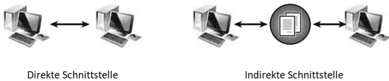
Abbildung 3-12: Direkte und indirekte Schnittstellen nach [EiRZ2014]
