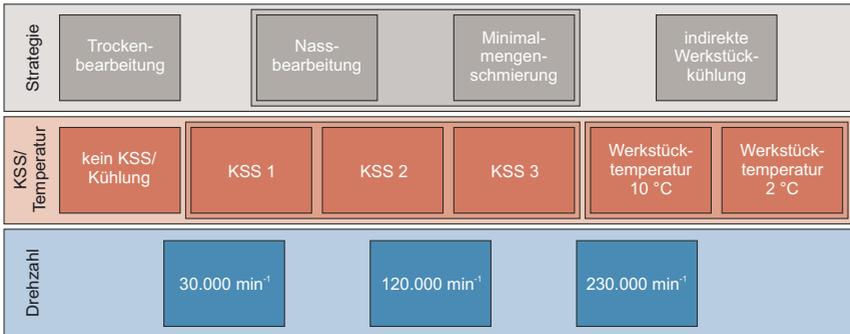
Abbildung 8-1: Darstellung der Untersuchungsschwerpunkte der Kühlschmierung auf das Mikrofräsen
