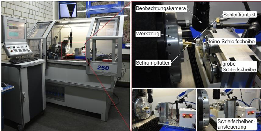
Abbildung 4-6: Versuchsaufbau Werkzeugherstellung
