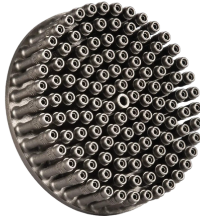
Abbildung 1.1: Injektorkopf eines Raketenantriebs der Ariane 6 Rakete als einzelnes Bauteil [2]; abgebildet mit Genehmigung von EOS und Ariane Group. Nicht Teil der übergeordneten CC-Lizenz.
