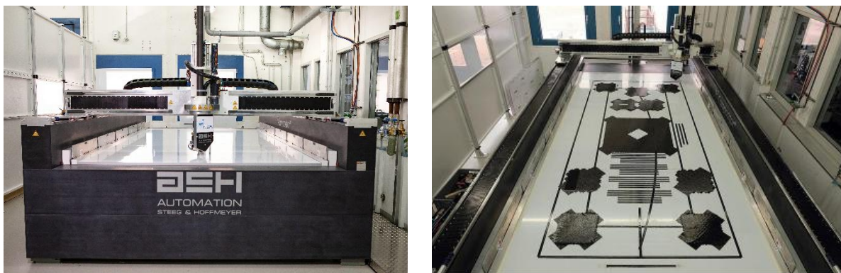
Abbildung 2.6: Portal-Legesystem für das Thermoplast-Tapelegen (beide Bilder: Copyright der Leibniz-Institut für Verbundwerkstoffe GmbH )
