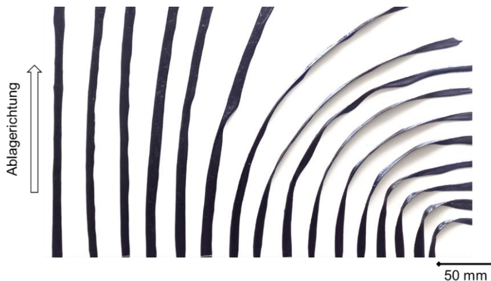
Abbildung 3.3: Freie Ablage in Radien mit 50K-Roving nach [27]
