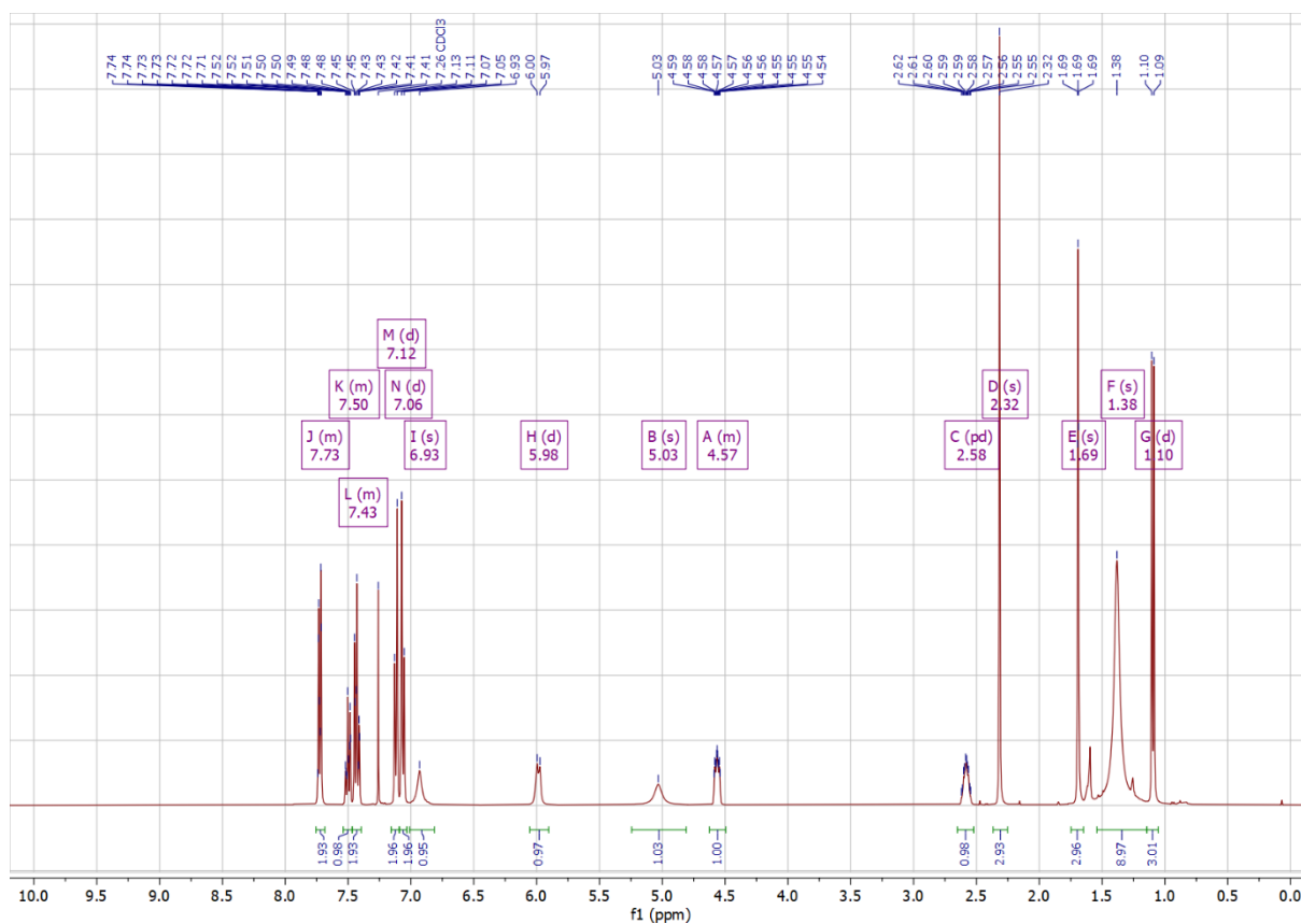
Abbildung 6.243: ^1\text{H} -NMR-Spektrum von Verbindung chiral-213 (in \text{CDCl}_3 ).
