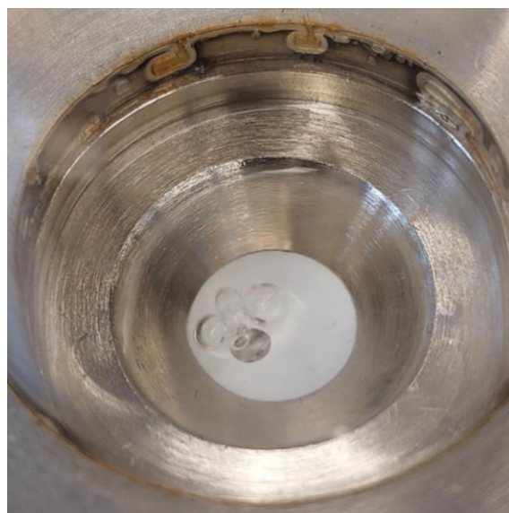
Abbildung 37: Blasenbildung beim Erreichen des Eintrittskapillardrucks
