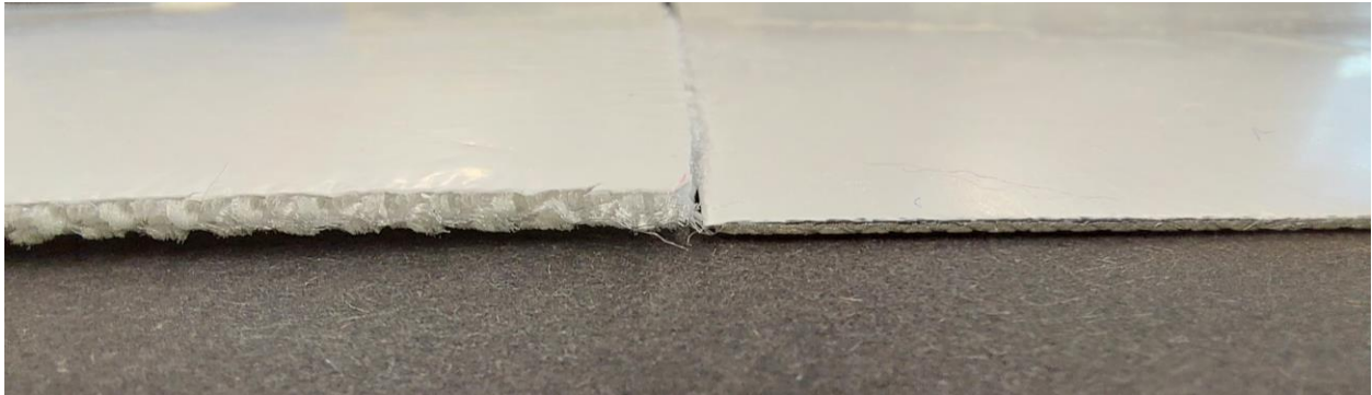
Abbildung 33: Punktverklebte Membran-Gewebe-Komposite Version 1 (links) und Version 2 (rechts)
