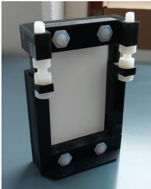
Abbildung 44: Micro-CT-Spannvorrichtung für Filterelemente mit geklebtem Membran-Gewebe-Komposit der zweiten Version
