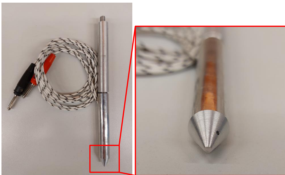
Abbildung 28: Punktheizstempel mit 2 mm Spitzendurchmesser
