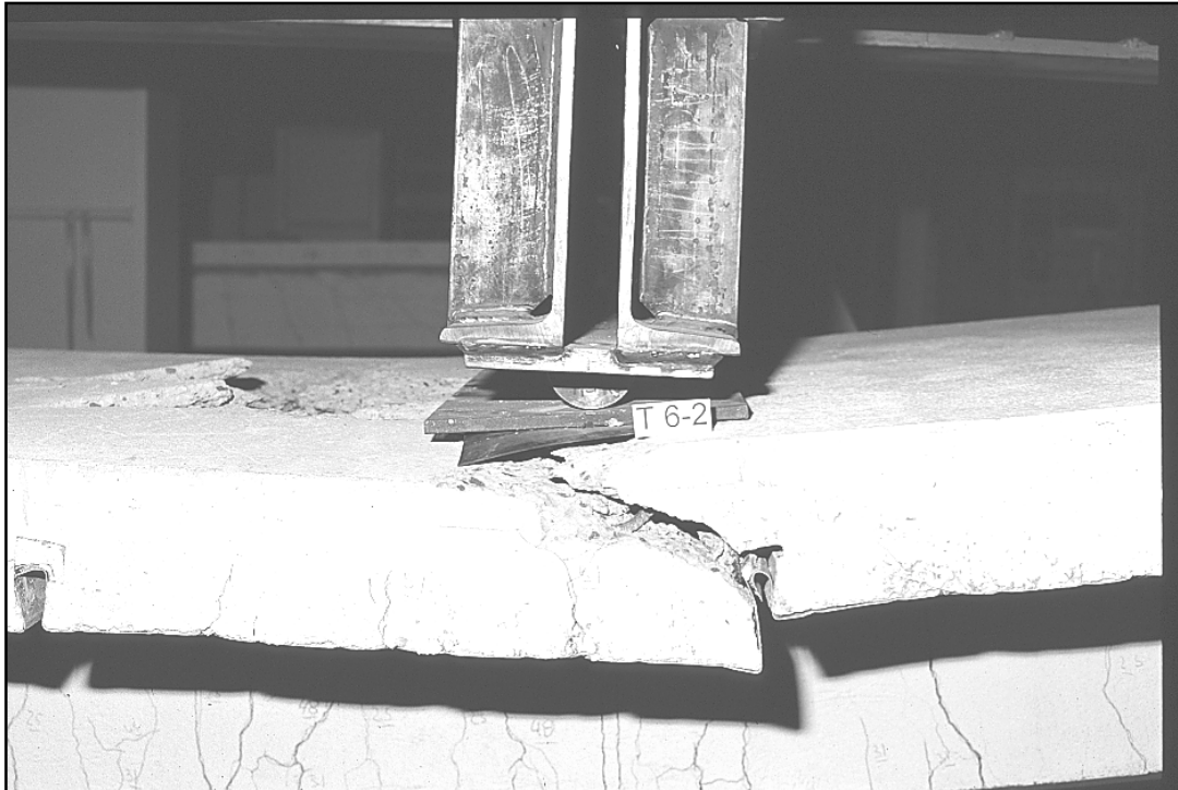
Bild 4.37 Druckversagen des Betongurtes im Feld, Versuch T6-2
