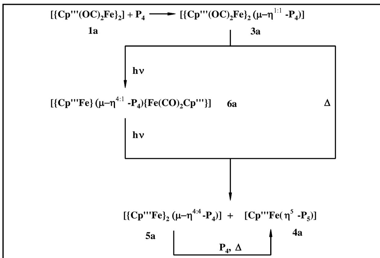
**Abb. 6.2:** Eisenkomplexe mit P<sub>4</sub>-Liganden als wahrscheinliche Vorstufen der Cyclopentaphosphaferrocene: Interkonversionsreaktionen am Beispiel der Cp<sup>III</sup>-Derivate
