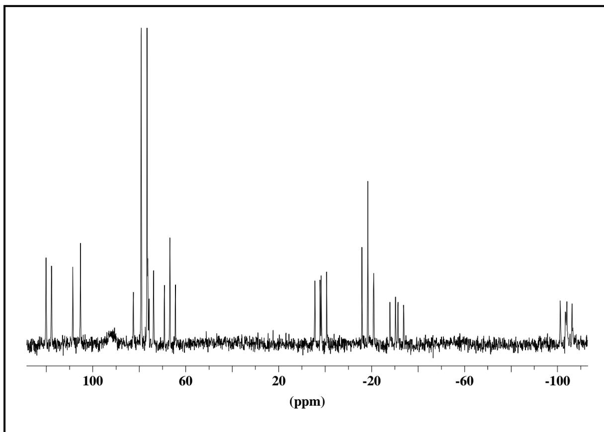
**Abb. 7.1:**  $^{31}\text{P}$ -NMR-Spektrum der Rohlösung nach 48-stündiger Cothermolysen von  $[\{\text{Cp}^{\text{III}}(\text{OC})_2\text{Fe}\}_2(\mu\text{-}\eta^{1:1}\text{-P}_4)]$  (**3a**) mit  $(\text{PhC})_2$  ( $\text{C}_6\text{D}_6$ ; 298 K)
