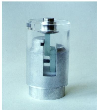
Abbildung 35: Druckscher-Versuch; Probe und Prüfvorrichtung
