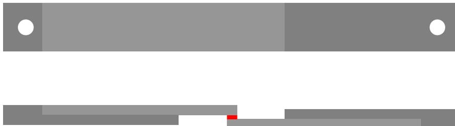
Abbildung 37: Schubspannungs-Gleitungs-Probe mit aufgeklebten Probeträgern
