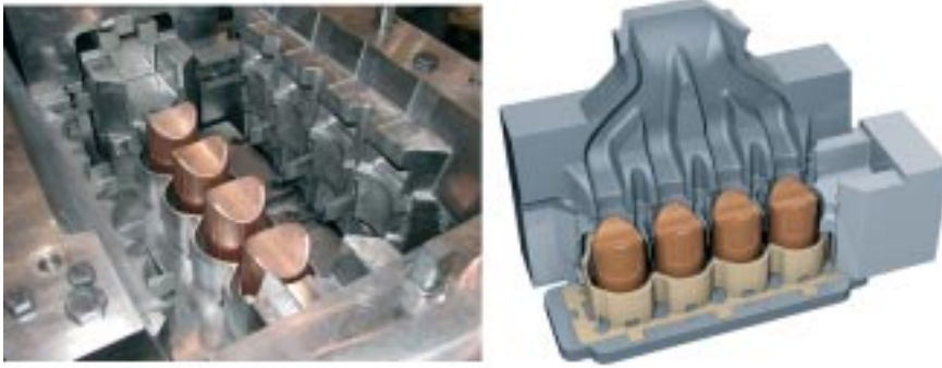
Bild 10: Kokille für open-deck Zylindereinsatz (links) und closed-deck Zylindereinsatz (rechts), schematisch Figure 10: Gravity die casting moulds for an open-deck cylinder insert (left) and a closed-deck cylinder insert (right, schematic)
