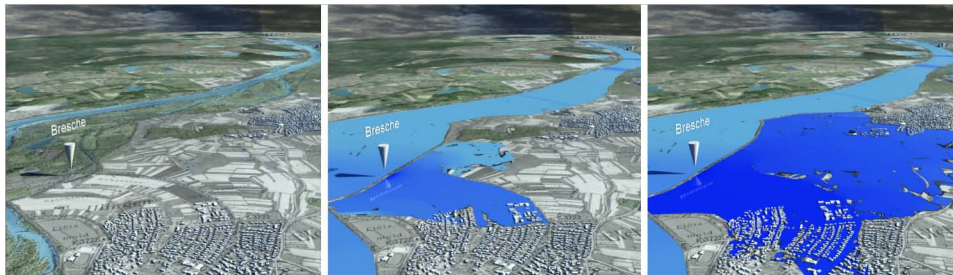
Abbildung 110: Die als TIN vorliegenden 2,5D - Wasserspiegel Geometrien: Vor dem Deichbruch mit der fiktiven Bresche (1), eine Stunde nach dem Deichbruch (2) und dem Wasserstand drei Stunden nach dem Deichbruch (3) [MACH 2010]
