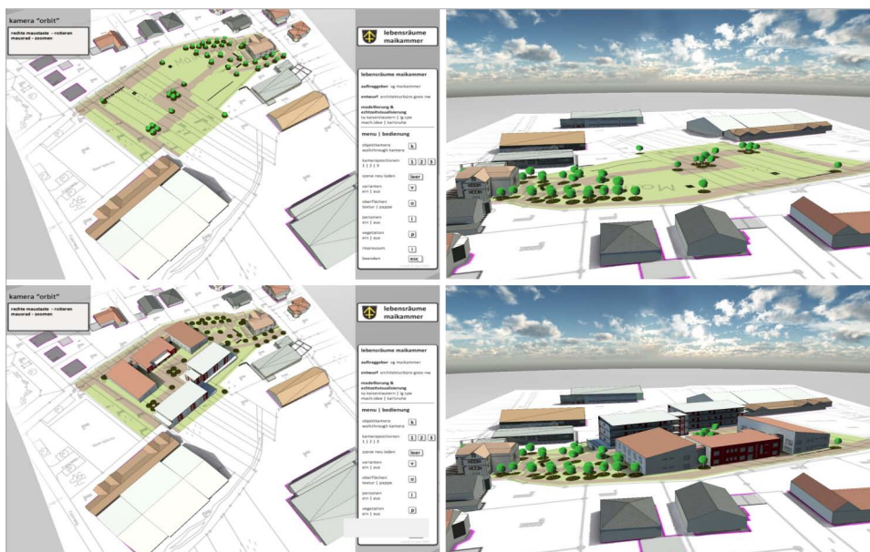
Abbildung 88: Bilder aus der Echtzeitsimulation, Variantenvergleich im mit Farbtextur belegten Modellbereich sowie Überprüfung der Höhenentwicklung innerhalb des Arealbereichs
