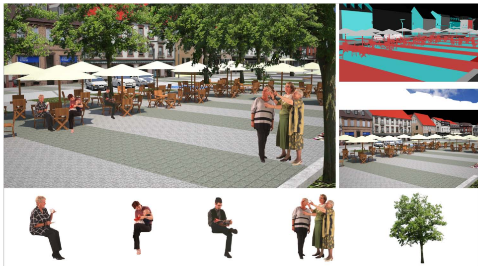
Abbildung 76: Das fertig montierte „Atmosphärenbild“ (1), rechts oben die Material-ID der im Modell vorhandenen Texturen (2), der hineinretuschierte Himmel (3) auf Grundlage des darunter liegenden Alpha-Kanalbildes), sowie das Ausgangsbild, das als Grundlage für die Montage diente (4). Im unteren Bereich links sind die Personen und die Vegetation zu sehen, die zusätzlich hinein retuschiert wurden (5).
