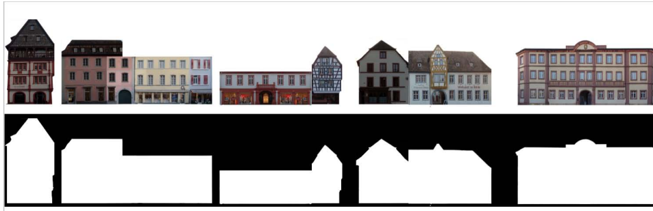
Abbildung 21: Beispiel einer Fassadenabwicklung durch aufgenommene Fotos bei der Erstellung eines 3D-Stadtmodells am Beispiel des Marktplatzes in Neustadt an der Weinstraße [Eigene Darstellung, mit Rückgriff auf Daten von NÉRÉ, SCHÄFER 2008 ]
