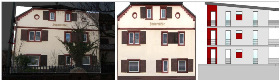
Abbildung 84: Perspektivische Entzerrung der aufgenommenen Fassadentexturen (1) mit anschließendem Retusche-Verfahren (2) und Darstellung eines aus den Ansichten entnommenen Fassaden-Mappings der neu zu beplanenden Gebäude (3)
