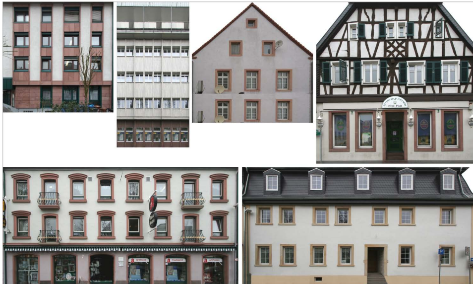
Abbildung 67: Perspektivisch entzerrte Texturen in der Orthogonalprojektion, in Power of Two Größe vorliegend
