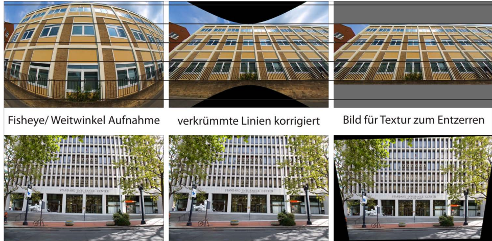
Abbildung 52: Vergleich der Originalfotos, aufgenommen mit einem Extrem-Weitwinkel oder Fisheye - Objektiv. Aus den horizontalen und vertikalen Linien werden die Krümmungen herausgerechnet und das Bild kann darauf ohne weitere Nachbearbeitung zu einer Textur durch perspektivisches Entzerren transformiert werden [Eigene Darstellung, unter Verwendung von NIEMANN 2009]
