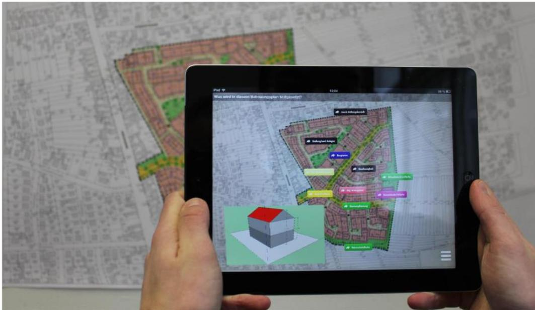
Abb. 34: Marker-basierte *Augmented Reality* auf Basis eines Bebauungsplans (Quelle: Broschart et al. 2013a)
