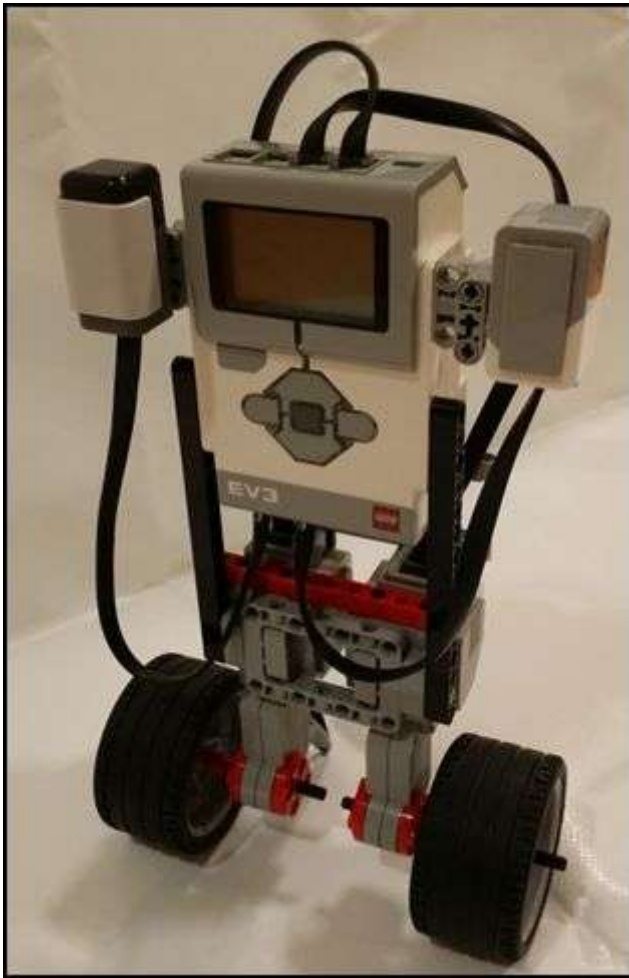
Abbildung 14: Der Lego-Segway mit hohem Schwerpunkt, sowie 2 Gyro-Sensoren
