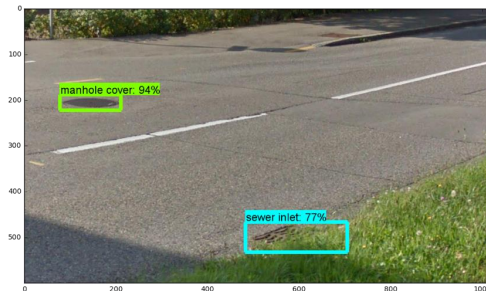
Abbildung 1: Detektion von Einlaufschächte (türkis) und Schachtdeckeln (grün) innerhalb eines Strassenbildes.
