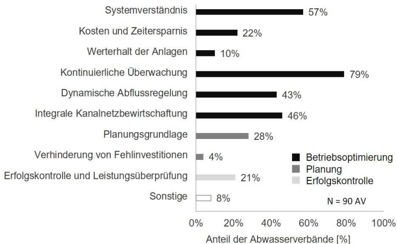
Abbildung 3: Motivation der Abwasserverbände (N=90 AV) in der Schweiz zum Einsatz von Messtechnik in RÜB. Messtechnik wird hauptsächlich zur Betriebsoptimierung verwendet und weniger um erfasste Messdaten für die Planung oder zur Erfolgskontrolle zu nutzen.
