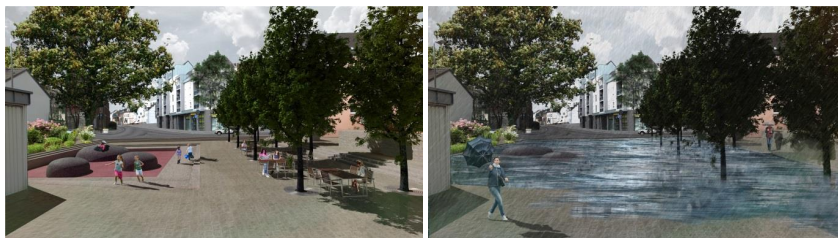
Abbildung 2: Visualisierung zu einem möglichen Umbau des Pfarrer-Oermann-Platzes in Köln-Eil als multifunktionale Fläche bei Trockenwetter (links) und bei Unwetter (rechts) (Benden et al. 2017)
