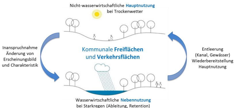
Abbildung 1: Funktionsprinzip eines multifunktionalen urbanen Retentionsraums
