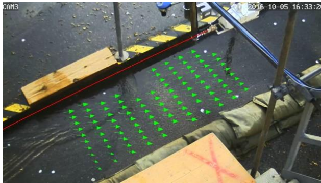
Abbildung 1: Ermittelte Fließgeschwindigkeitsvektoren von der SSIV-Methode.
