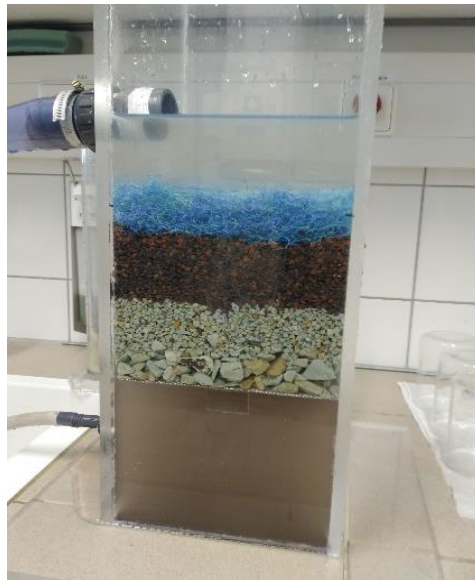
Abbildung 8: Filtrationsversuche in einer aufwärts durchströmten Laboranlage zum Rückhalt von Feinpartikeln mit unterschiedlichen Substraten
