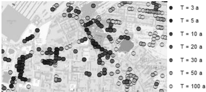
Abbildung 8: Überstauete Schächte bei der Kanalnetzsimulation mit seltenen Starkregen
