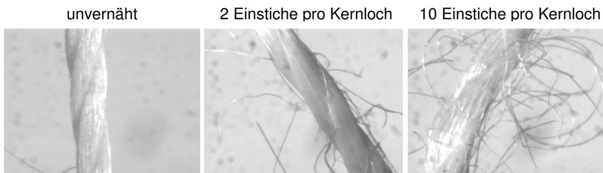
Bild 5.9: Schädigung des zuerst eingebrachten AF-Nähfadens durch mehrmaliges Einstechen in dasselbe Kernloch
