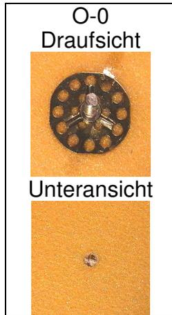
Bild A 1.1: Unvernähte und mit Harz imprägnierte Onsert-Variante
