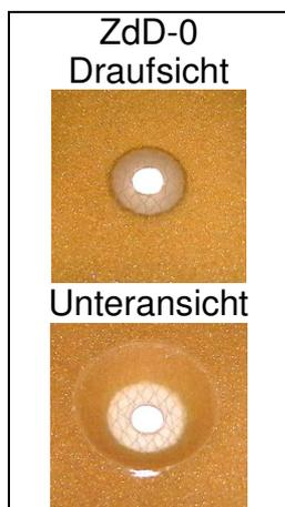
Bild A 1.3: Unvernähte und mit Harz imprägnierte ZdD-Variante
