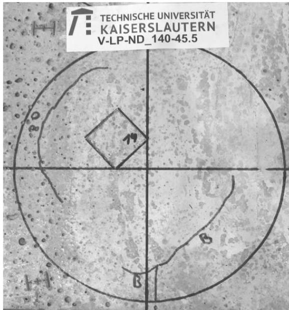
Abb. E.22: Versuch V-LP-ND\_140-45.5: Rissverlauf nach Erreichen der lokalen Durchstanztragfähigkeit
