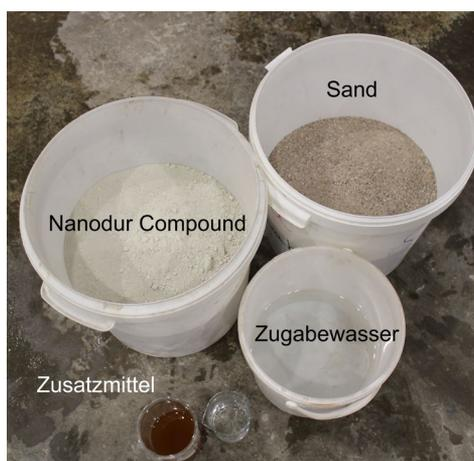
Abb. 3.1: Bestandteile eines Hochleistungsbetons auf Grundlage der Bindemittelvormischung Nanodur® Compound 5941
