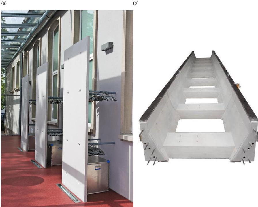
Abb. 3.3: Garderobenstelen im Bibelhaus Frankfurt am Main (a) (*OpusC 2011*) sowie Maschinenbett für eine Fahrständermaschine (b) (*Sagmeister 2017*) aus Nanodur®-Beton
