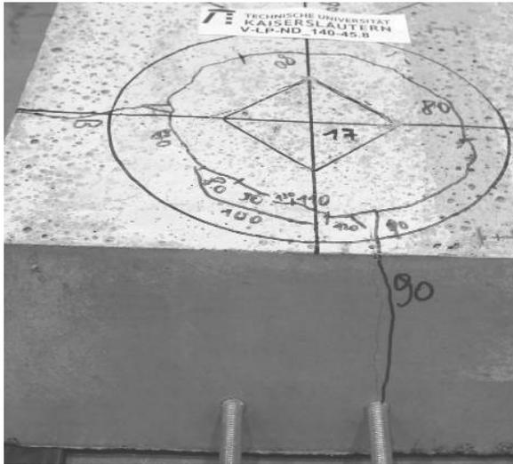
Abb. E.26: Versuch V-LP-ND\_140-45.8: Rissverlauf nach Erreichen der lokalen Durchstanztragfähigkeit im Bereich der Probekörperaußenflächen (Seite 1)
