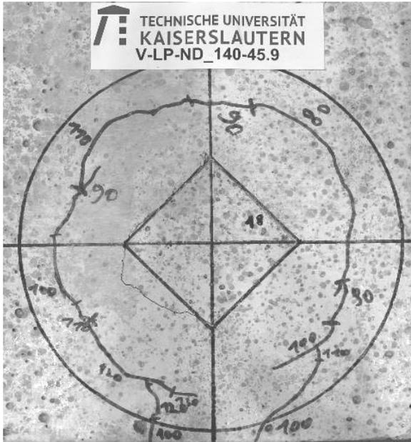
Abb. E.28: Versuch V-LP-ND\_140-45.9: Rissverlauf nach Erreichen der lokalen Durchstanstragfähigkeit
