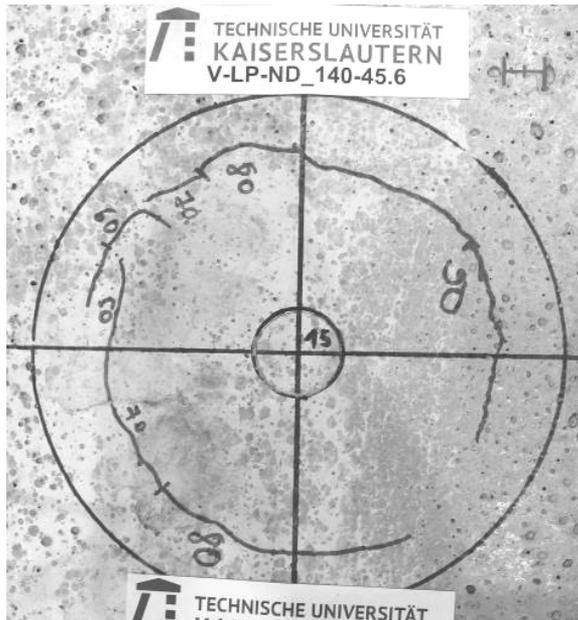
Abb. E.23: Versuch V-LP-ND\_140-45.6: Rissverlauf nach Erreichen der lokalen Durchstanztragfähigkeit
