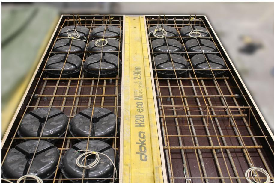
Abb. 3.9: Herstellung zweier Probekörper mit Hohlkörpern
