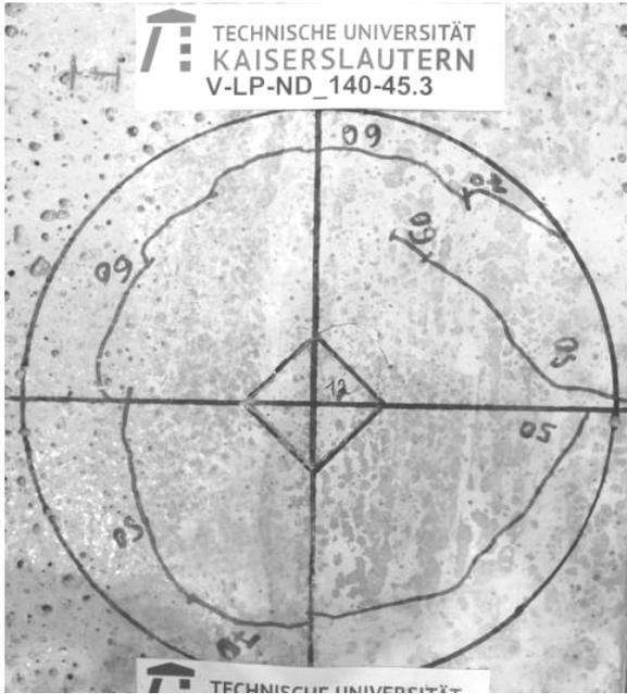
Abb. E.18: Versuch V-LP-ND\_140-45.3: Rissverlauf nach Erreichen der lokalen Durchstanztragfähigkeit
