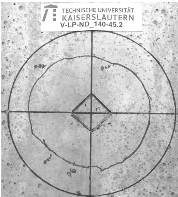
Abb. E.17: Versuch V-LP-ND\_140-45.2: Rissverlauf nach Erreichen der lokalen Durchstanstragfähigkeit
