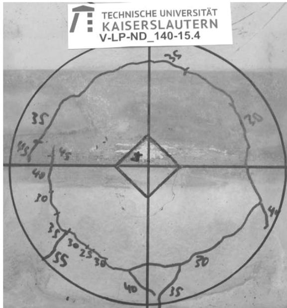
Abb. E.6: Versuch V-LP-ND\_140-15.4: Rissverlauf nach Erreichen der lokalen Durchstanztragfähigkeit
