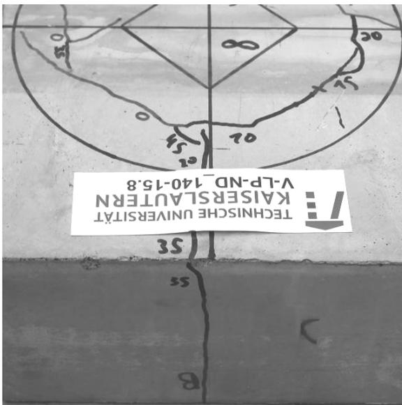
Abb. E.13: Versuch V-LP-ND\_140-15.8: Rissverlauf nach Erreichen der lokalen Durchstanstragfähigkeit im Bereich der Probekörperaußenflächen (Seite 2)
