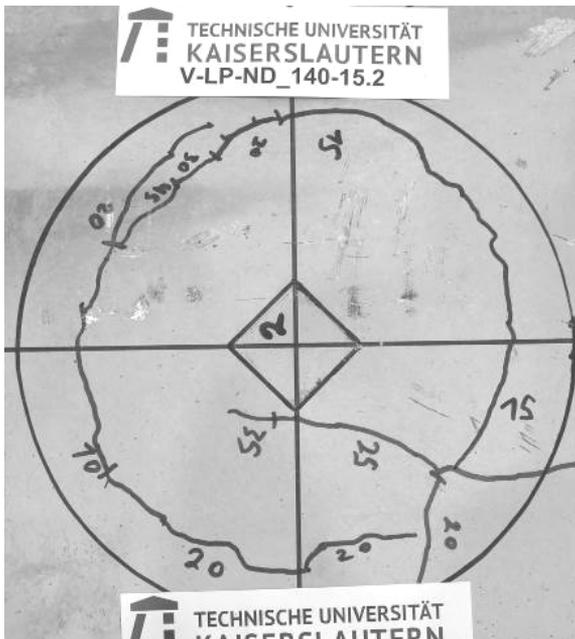
Abb. E.3: Versuch V-LP-ND\_140-15.2: Rissverlauf nach Erreichen der lokalen Durchstanztragfähigkeit
