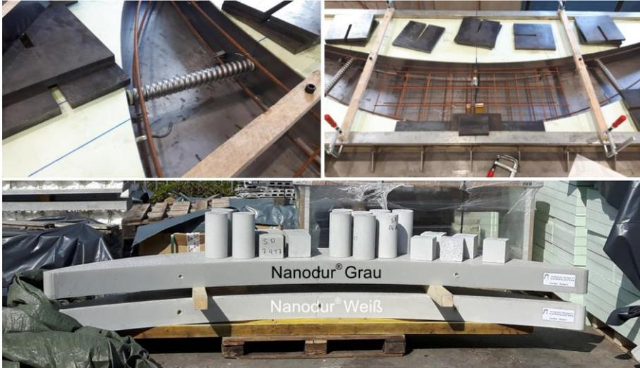
Abb. 7.9: Schalung mit Hüllrohr (oben links), Schalung mit Transportanker (oben rechts), Sichel für das Probeelement (unten)
