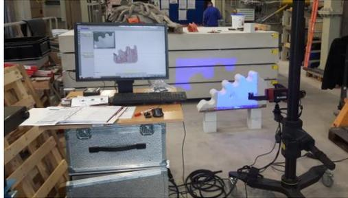
Abb. 7.5: Scanvorgang Zahnradsegment
