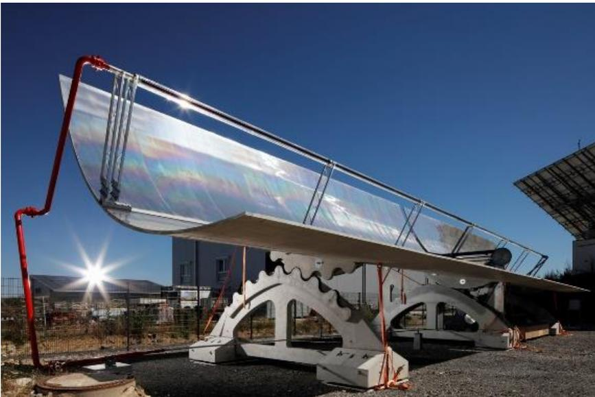
Abb. 7.44: Fertiger Großdemonstrator mit Verzahnung
