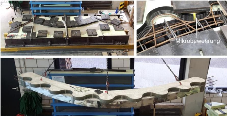
Abb. 7.35: Schalung mit Gewichten (oben links), Mikrobewehrung (oben rechts), Lauffläche mit unterer Verzahnung (unten)
