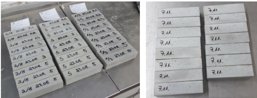
Abb. 5.10: Ausgeschaltete Probekörper der Versuchsreihe I (links), Ausgeschaltete Probekörper der Versuchsreihe II (rechts)
