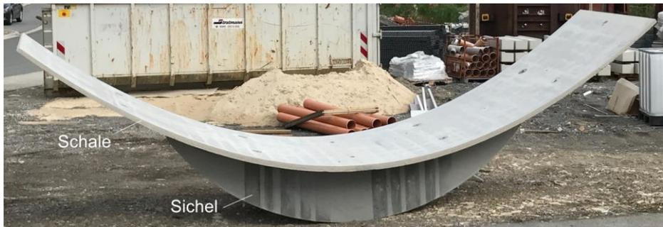
Abb. 7.10: Fertiggestelltes Probeelement
