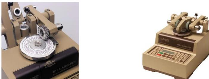
Abb. 3.8: Prüfteller mit Reibrad (links), Taber-Abriebprüfgerät (rechts) (Direct 2019)
