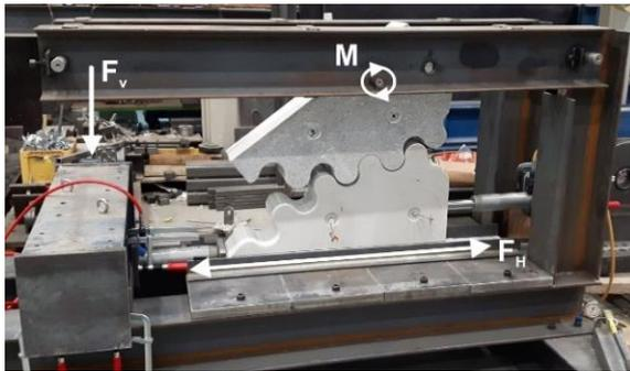
Abb. 7.7: Prüfstand für das Abrollen von Verzahnungen aus Hochleistungsbeton
