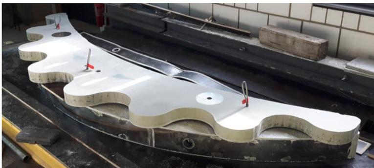
Abb. 7.39: Über Orbiter verbundene Sichel und obere Verzahnung
