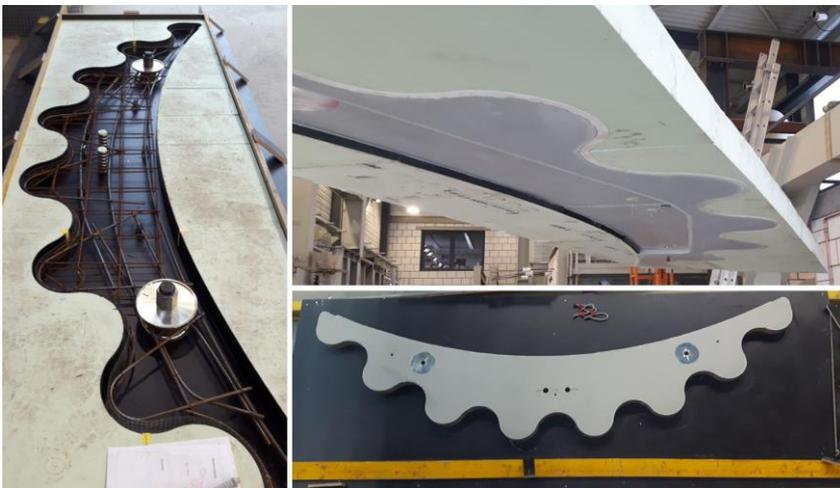
Abb. 7.38: Bewehrung (links), Vertiefung (oben rechts), obere Verzahnung (unten rechts)
