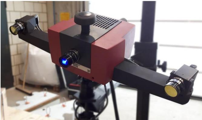
Abb. 3.11: ATOS Compact Scan 5M (Technische Universität Kaiserslautern)
