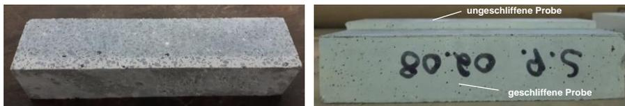
Abb. 5.12: Geschliffenes Prisma (links), Prismenvergleich (rechts)
