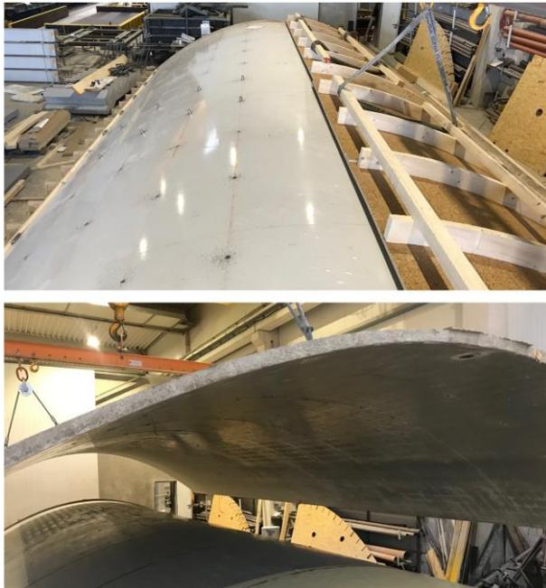
Abb. 7.41: Schalung (oben), Schale (Bildquelle: Stanecker Betonfertigteilterwerk)
