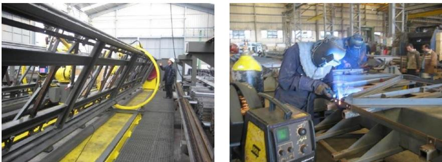
Abb. 2.7: Fertigung von Stahlfachwerken für Parabolrinnen (*GIZ 2014*).
