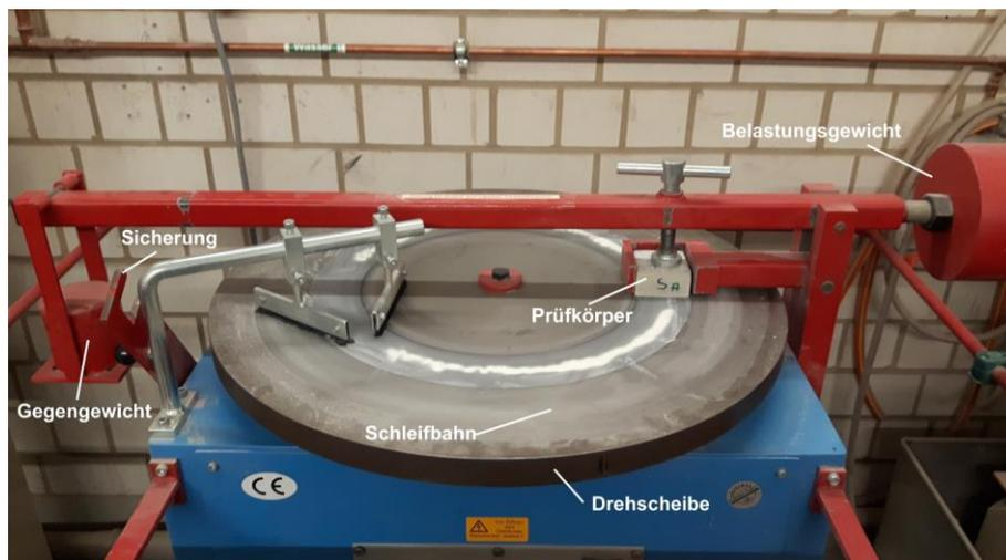
Abb. 5.4: Böhmscheibe im Labor für Konstruktiven Ingenieurbau
