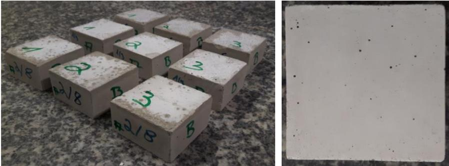
Abb. 5.3: Probekörper für Böhmischeibe (links), Unterseite der Probekörper (rechts)
