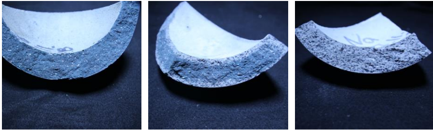
Abb. 7.7: Betonbruchflächen N-WB, N-WL und N-RF (von links nach rechts)
