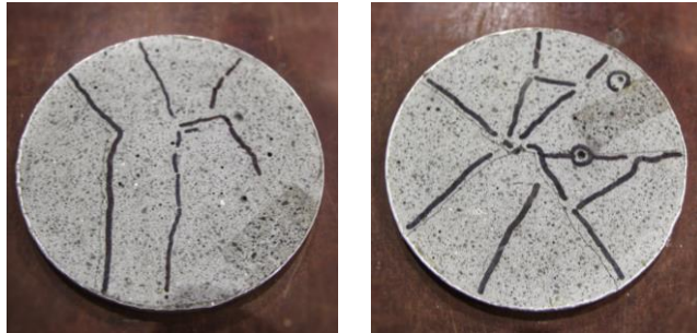
Abb. 5.11: Durch erhöhten Druck gerissener Betonscheibe ( d = 1,5 \text{ cm} ) aus UHPC
