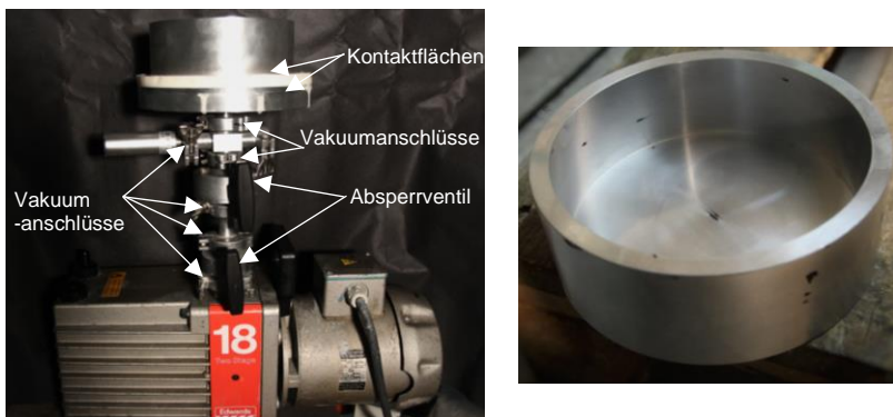
Abb. 5.10: Links: vorhandene Leckstellen im neuen Messverfahren; rechts: zylinderförmiger Referenzprüfkörper zur Erfassung der Leckrate des Kontakts Silikon-Prüfkörper
