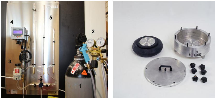
Abb. 4.11: Links: Versuchsaufbau bestehend aus: 1. Gasflasche, 2. Druckminderer und Manometer, 3. Präzisionsdruckregler, 4. Elektronisches Anzeigegerät, 5. Glasrohre (Blasenähler); rechts: Prüfzelle mit seitlicher Abdichtung
