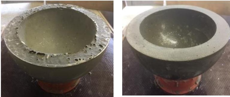
Abb. 6.8: Links: Zustand der Auflagefläche der Betonschale vor der Vorbereitung; rechts: Zustand der Auflagefläche nach der Vorbereitung (Sousa Rodrigues 2019)
