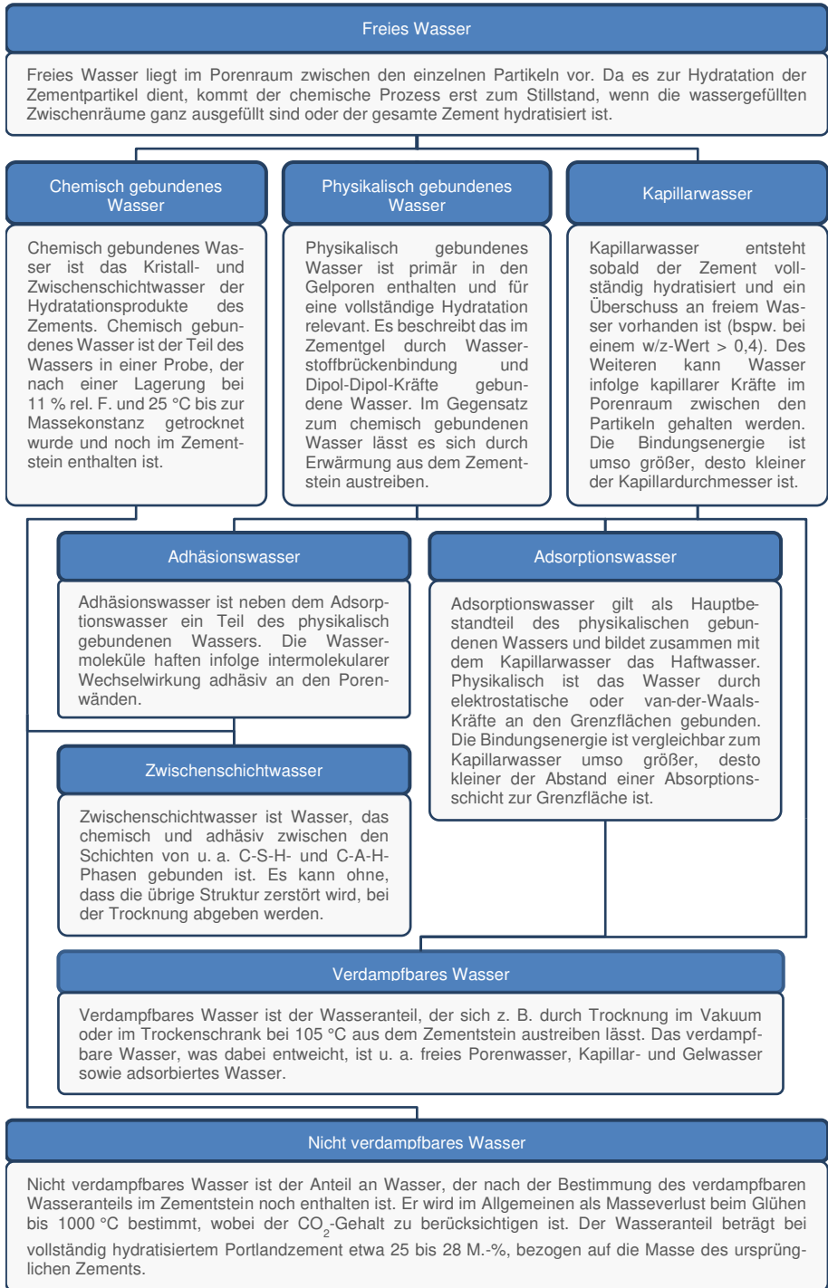
Abb. 2-21: Wasseranteile in der Zementsteinmatrix nach [50–52]
