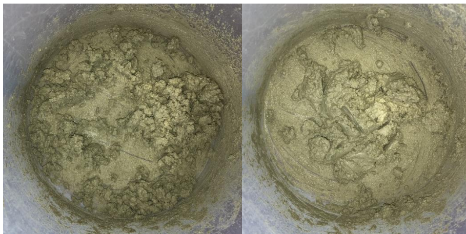
Abb. 3-19: Exemplarische Darstellung des Kornhaufwerks bei Sättigung (links) sowie bei einem Überschuss an Feuchtigkeit (rechts)
