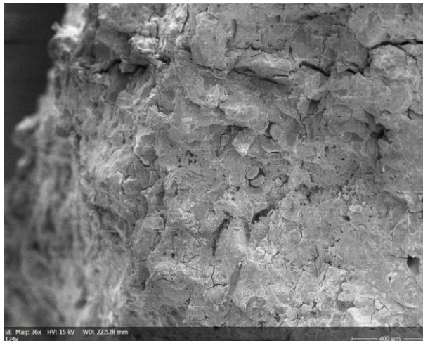
Abb. 3-90: Oberflächenstruktur eines in Wasserglas gelagerten Probekörpers
