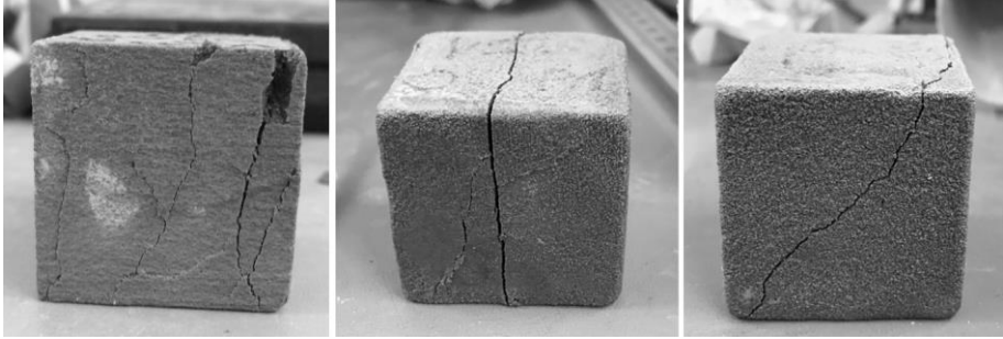
Abb. 3-78: Exemplarische Bruchbilder der Versuchsserie GK°
