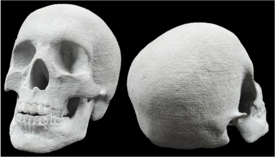
Abb. 2-12: Veranschaulichung der realisierbaren Auflösung mit dem 3DP-Verfahren (Größe: ca. 13 x 9 x 8 cm) (vgl. [14])
