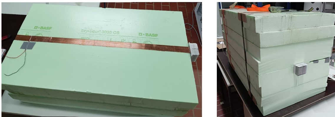
Abbildung 28 links: Peltier-Element zwischen den zwei unterschiedlich langen Kupferstäben rechts: fertiger Versuchskörper mit neuen Abmessungen
