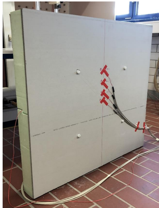
Abbildung 30 links: erster Prototyp ohne Gipskartonplatte, Temperaturmessung auf der Aluminiumplatte rechts: erster Prototyp mit Gipskartonplatte, Temperaturmessung auf der Gipskartonplatte
