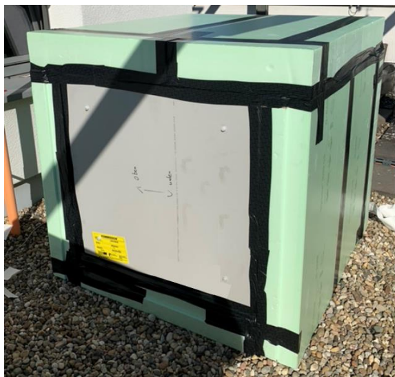
Abbildung 31 links: fertiger Kubus im Außenbereich der TU Kaiserslautern mit eingebautem Prototyp rechts: Messtechnik im Innenraum des Kubus
